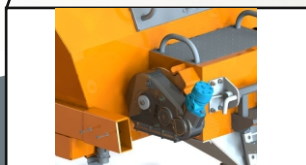
Привод транспортера - мотор-редуктор с усиленным креплением
