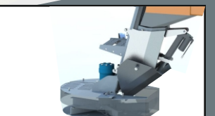
Механизм дистанционного изменения асимметрии посыпки
